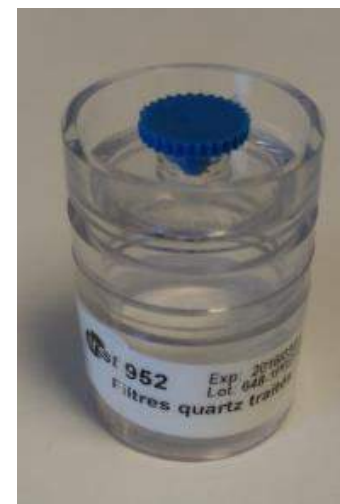
Cassette 952, 3 pièces, 25 mm, filtres de quartz
