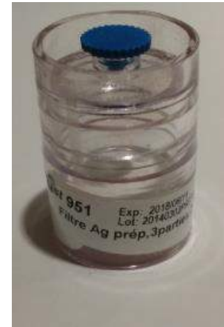
Cassette 951, 3 pièces, 25 mm, filtre d'argent pré-pesé
